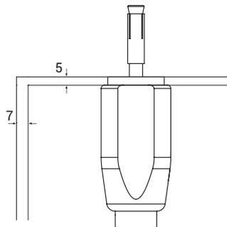
Pivote fijo para anclar en viga superior de concreto
